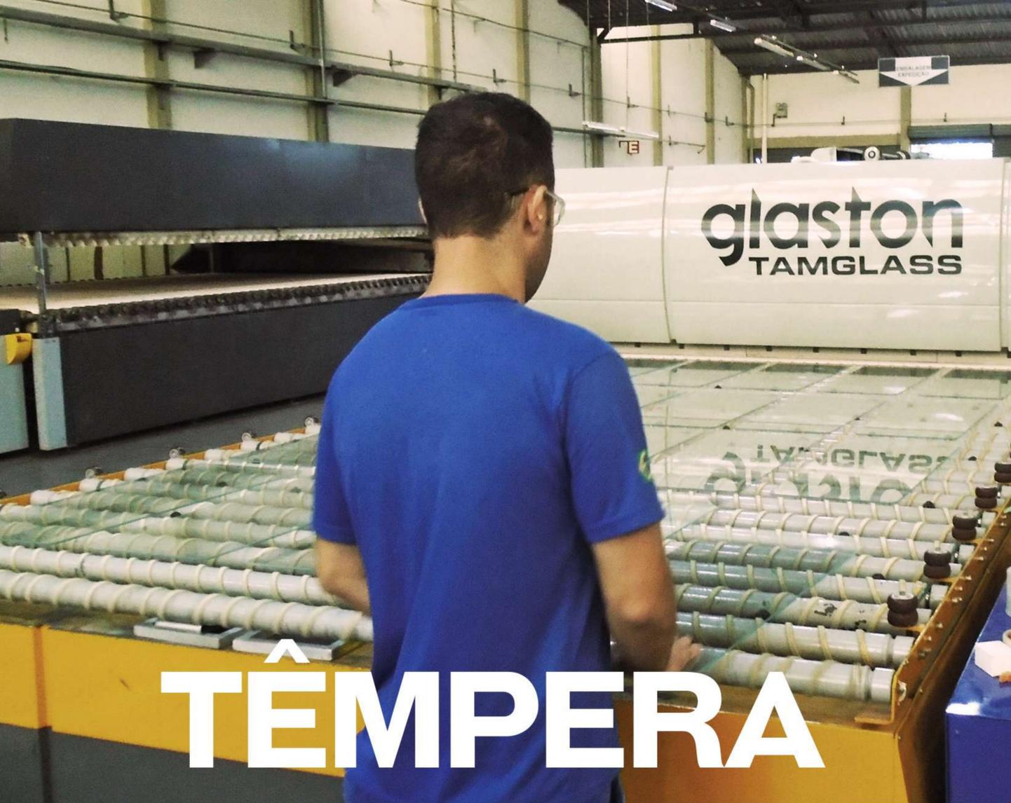
A Tecglass está equipada com fornos para a temperagem de vidros, tornando-os vidros de segurança de acordo com a norma ABNT NBR 7199. Após o processo de têmpera o vidro mantém seu aspecto original mas se torna de 4 a 5 vezes mais resistente que um vidro comum, e quando se quebra ele se estilhaça em pequenos fragmentos pouco cortante.
